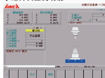
執行手動刀長量測後，控制器自動計算被量測刀具之刀尖位置，自動輸入刀長補正表
