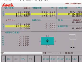
透過量測矩形工件的 A、B、C、D、E 五點座標，可計算出矩形工件的中心點座標和傾斜角；並可將計算出的工件中心點座標輸入至工件座標系統中 (G54 ~ G59)
