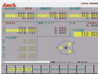
簡化量測圓形工件中心座標，依圖示量測 A、B、C 三點座標，即可求出正確的圓形工件中心點座標
