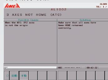
機台發生警報時，可顯示故障發生原因與排除步驟，可讓操作者自行排除簡單的故障問題，減少機台停工時間
