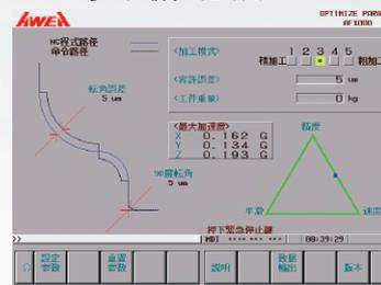
從粗加工到精加工階段，操作者可依據實際加工需求，先選擇輸入加工模式、再定義容許誤差與工件重量，即可以獲得最佳加工參數設定
