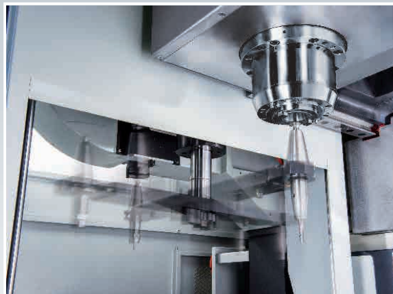
標準配備高效率 32 T 刀臂式換刀系統， 另可選配 40 T / 60 T 刀庫
